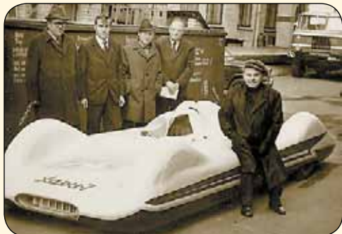
Владимир Константинович Никитин и сконструированный под его руководством ХАДИ-7. Расчётная скорость машины — 400 км/ч, но из-за отсутствия в СССР гладкой прямой трассы достаточной длины аппарат удалось разогнать только до 320 км/ч (неофициальный рекорд Союза).
